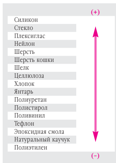
Рис. 1. Трибоэлектрическая шкала. При трении двух материалов тот из них, что расположен в ряду выше, заряжается положительно и тем сильнее, чем более разнесены материалы по шкале.
